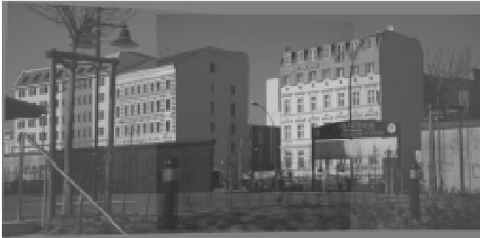
*fig. 3b: modèle projectif appliqué à une rotation. Les images sont superposées en transparence. On constate que le modèle translationnel est peu adapté pour restituer une image prise en effectuant une rotation avec l'appareil photo. Sur cette image on peut apercevoir le phénomène de parallaxe: la lampe qui se trouve en bas de l'image apparaît double.*
