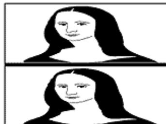
Ce format a été conçu pour permettre la visualisation stéréo sur des équipements standards (moniteur PC, télévision ou vidéo). A chaque rafraîchissement de l'écran, le champ se compose des deux images disposées l'une sous l'autre, compressées d'un facteur deux dans le sens de la hauteur.
